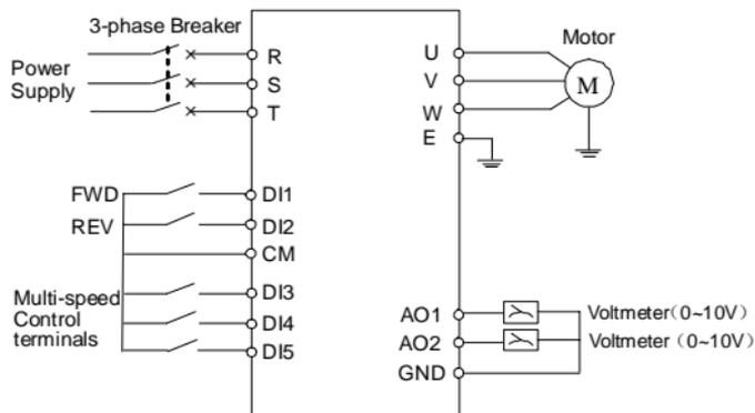
Fig9-3 Basic wiring
